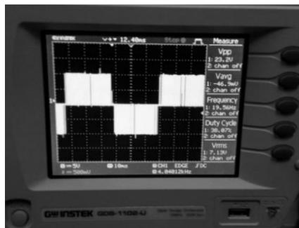
Gambar 9. Bentuk gelombang Output Inverter
