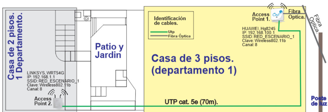
Figura 1-ANEXO A: Implementación de la red SOHO Ethernet (IEEE 802.3) con WiFi (IEEE 802.11b).
