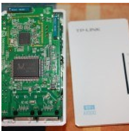
Figura 18-2: PLC desmontado la carcasa superior.
