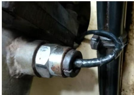
**Figura 4-3:** Sensor de temperatura de refrigerante
