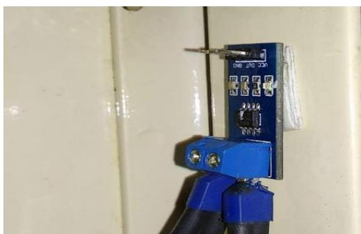
**Figura 8-3:** Sensor de corriente del ventilador
