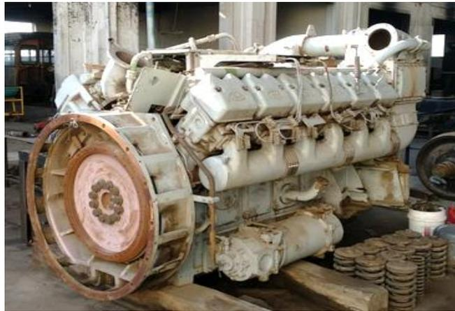
**Figura 26-2:** Motor Diésel de las locomotoras de FEEP
