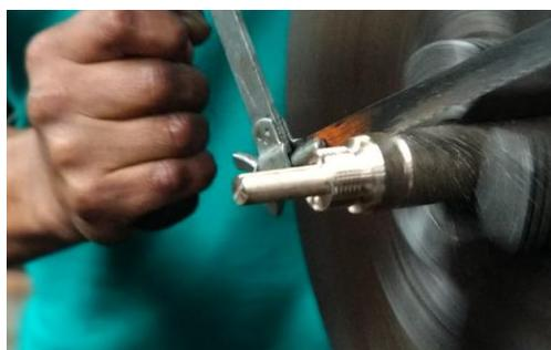
**Figura 6-3:** Elaboración de termo pozos para sensores de temperatura
