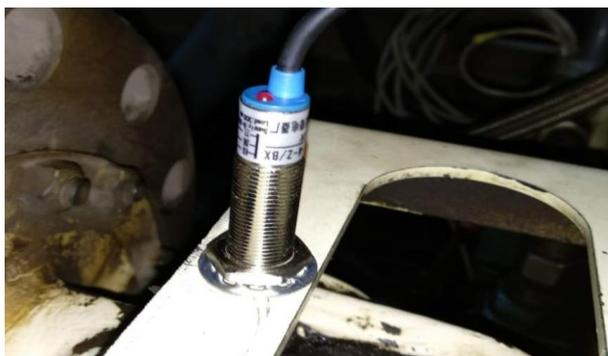
**Figura 7-3:** Sensor de revoluciones del motor diésel
