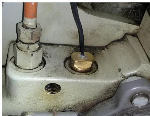
**Figura 5-3:** Sensor de temperatura de aceite
