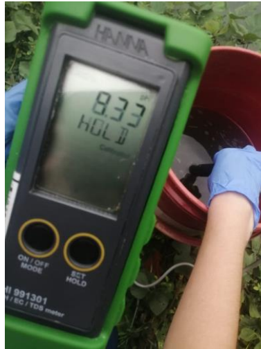
Ilustración 16. Evidencia medición parámetros salida PTAR.
