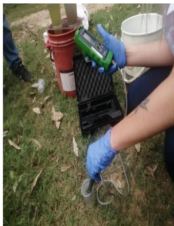
Ilustración 15. Evidencia toma de parámetros, entrada laguna
