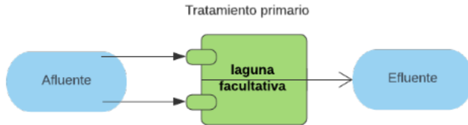
Ilustración 9. PFD tratamiento existente
