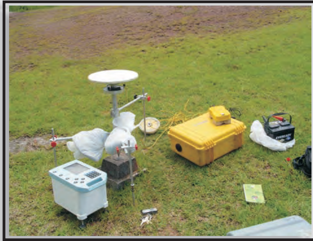
Figura 1. Gravímetro LaCoste & Romberg GRAVITON EG en la estación NOAA-NGS de la UNAH. (caja con panel azul). Antena y receptor de GPS Trimble 5700. La batería de 12V alimenta al receptor de GPS.
