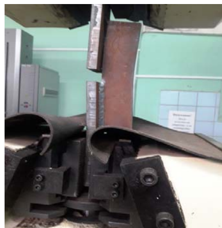
Рис. 6. Испытание образца на машине WAW-1000
