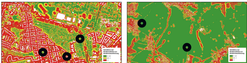
Abb. 3: Abschätzung der Standortqualität durch Analyse Digitaler Oberflächenmodelle und der Berechnung von Abschattungen durch Objekte wie Bäume oder Gebäude (Quelle: eigene Darstellung)
