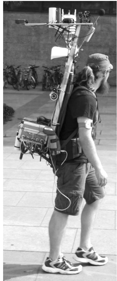
Abb. 2: Mobiles Meßsystem auf dem Rucksack im Einsatz (Foto: Queck 2018)
