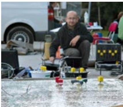
Interdisziplinäre Forschung an der HTWK Leipzig: Die Kapillardrucksensoren helfen, Beton rechtzeitig nachzubehandeln und so Fröhschädigungen zu vermeiden. Sie wurden zusammen von Ingenieuren der Fakultäten Bauwesen sowie Elektrotechnik und Informationstechnik entwickelt. | Foto: Stephan Thomas
