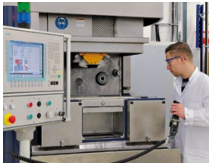
Die Arbeitsgruppe Wafering im Fraunhofer Technologiezentrum Halbleitermaterialien Freiberg beschäftigt sich mit dem Sägeprozess zur Herstellung von Wafern. Zu diesem Zweck ist eine Slurrydrahtsäge sowie eine speziell für Diamantdraht umgerüstete Säge im Hause vorhanden. Das Hauptaugenmerk liegt auf der Grundlagenforschung des Sägeprozesses und im Vergleich der beiden Technologien. | Foto: THM
