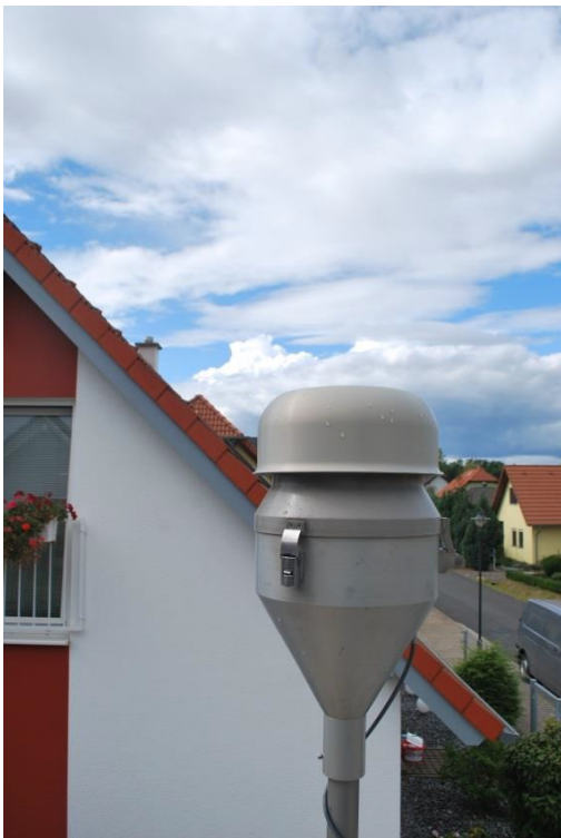
Abbildung 4: Probenahme Sammlung von Feinstaub PM10, Foto: Holm Kühne (BfUL)
