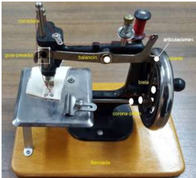
Figura 2. Maqueta de máquina de coser manual con la indicación de elementos y enlaces
