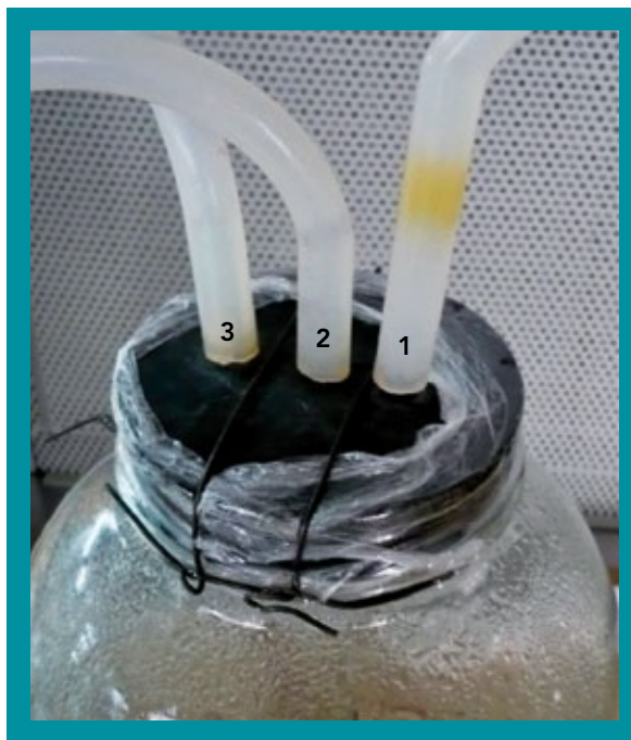
Figura 3. Tapones de caucho, usados para la construcción del biorreactor, el tubo 1, permite el recambio de medio entre los dos frascos; el tubo 2, está conectado a una válvula solenoide que se abre para permitir la salida moderada de aire y así liberar presión dentro del frasco; el tubo 3, está conectado a la bomba de aire. La flecha señale cierre hermético de alambre que asegura las tapas.
