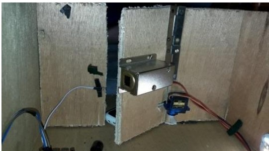
Gambar 2. Pintu dengan kunci selenoid
