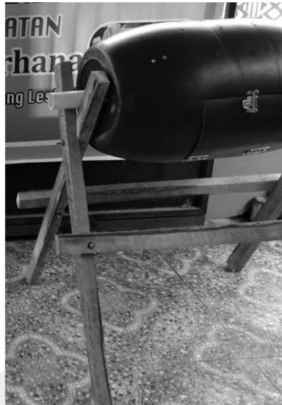
Gambar 1. Drum composter dengan tiang penyangga.
