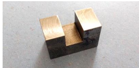
Gambar 9. Benda kerja setelah proses EDM
