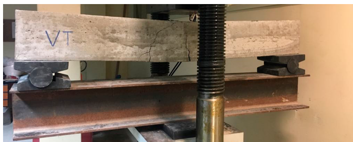
Figura 5 – Abertura de fissuras da viga VT
