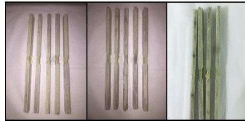
Gambar 8. Bentuk patahan spesimen Uji Tekan
