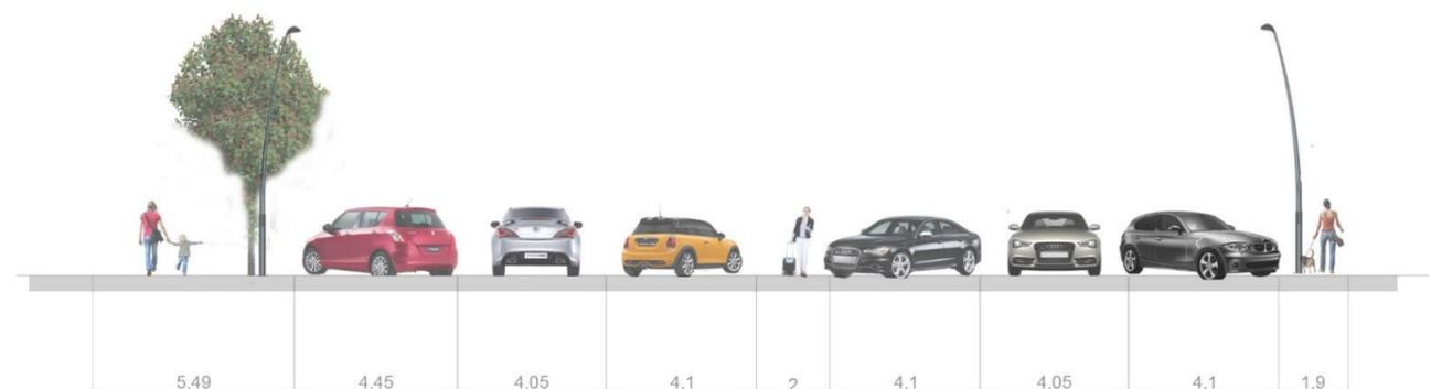
Imagen 28: Sección del parking al sur de la estación. Fuente: Elaboración Propia.
