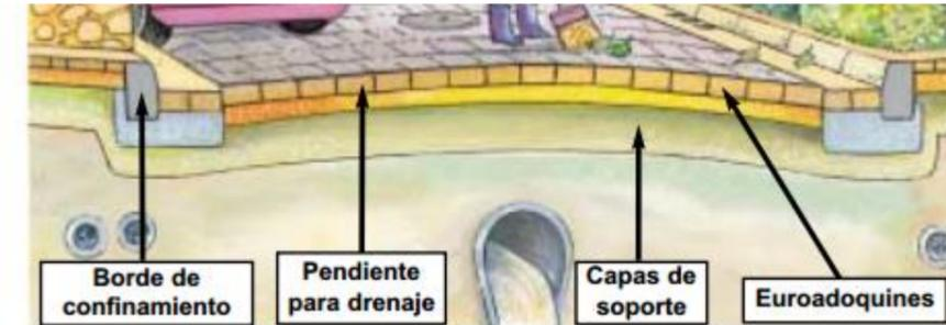
Imagen 8: Sección de adoquines en bóveda. Fuente: Manual técnico de proyecto, diseño y uso de los Euroadoquines.
