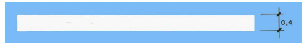
Imagen 4: Señal M-4.1. Fuente: Norma 8.2-IC Marcas viales.
