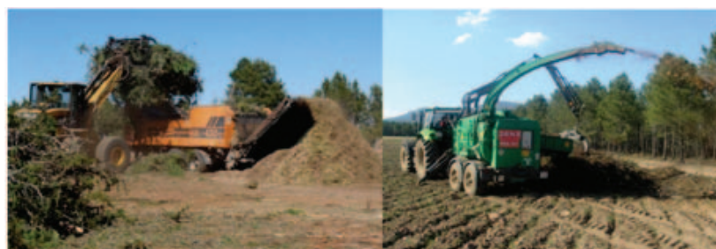
Triturado y astillado de biomasa (izquierda y derecha respectivamente)
