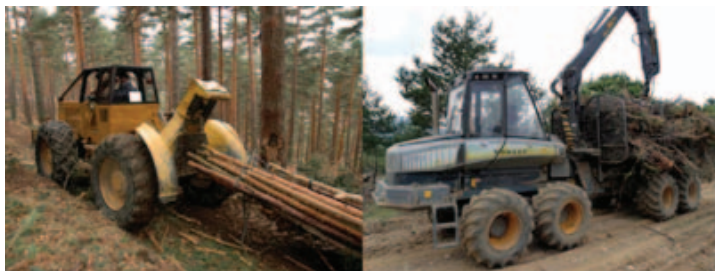
Skidder (izquierda) y autocargador (derecha)
