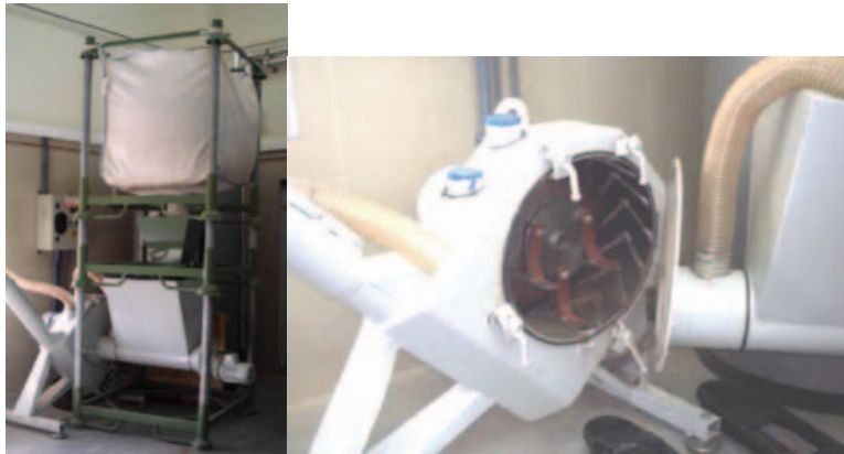
Figura 3. Molino de martillos planta piloto de pelletizado.
