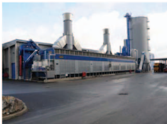
Figura 6. Imagen de secadero de banda de baja temperatura de la compañía STELA [9]
