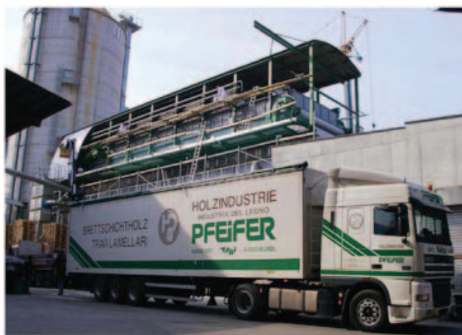
Figura 5. Imagen de una instalación real de secadero de banda marca SIWSS COMBI tipo KUVO en la empresa PFEIFER en Austria [8]
