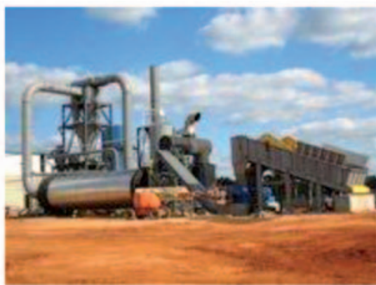
Figura 3. Imagen de secadero de tambor rotativo ECPI modelo Z8 [7]
