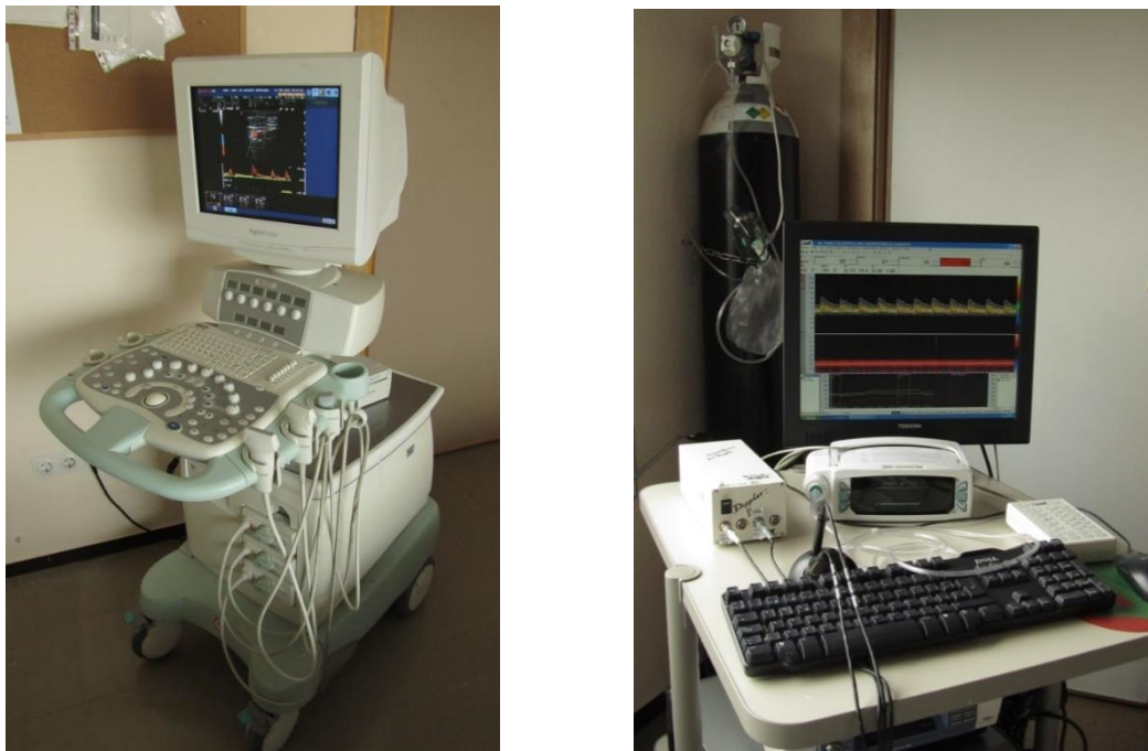
Figura 11: A. Ecógrafo Esaote MyLab 70. B. Equipo Doppler DWL Box, capnógrafo y bala de CO2.
