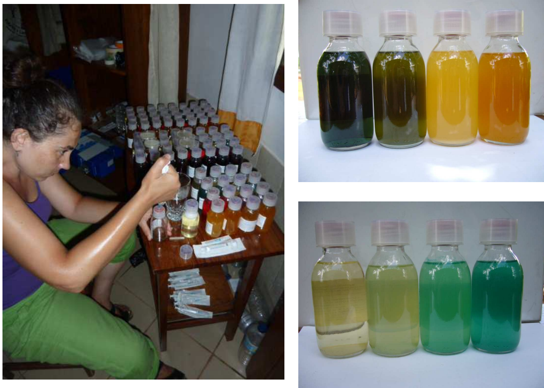
Foto 5. Análisis microbiológico. Viraje y categorías de color para V. cholerae (arriba) y E. coli (abajo).
