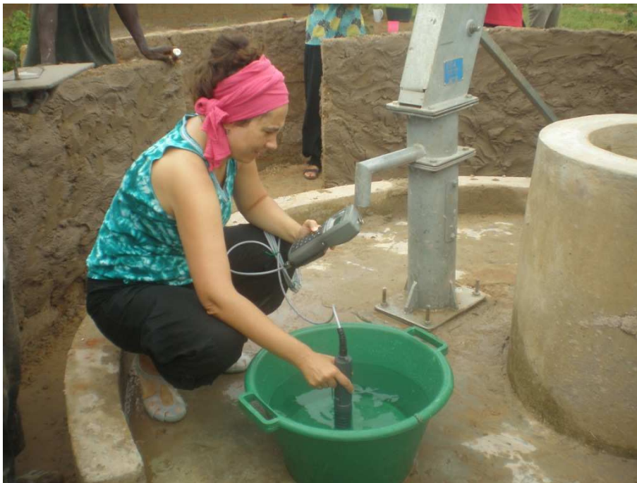
Foto 12. Medida in situ de la conductividad del agua.
