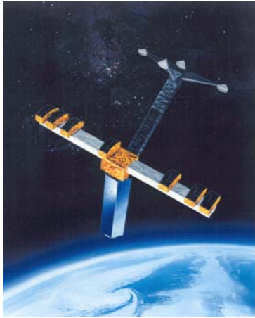
Figura 2.7: Diseño propuesto para la misión SIM (“Space Interferometry Mission”), donde siete cristales ópticos se montan sobre una estructura articulada (NASA) (Joshi, 1999)
