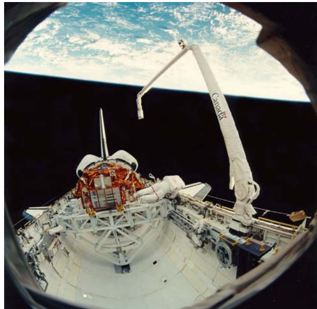
Figura 1.2: Brazo robótico montado sobre una plataforma espacial SRMS (“Shuttle Remote Manipulator System”) (NASA)
