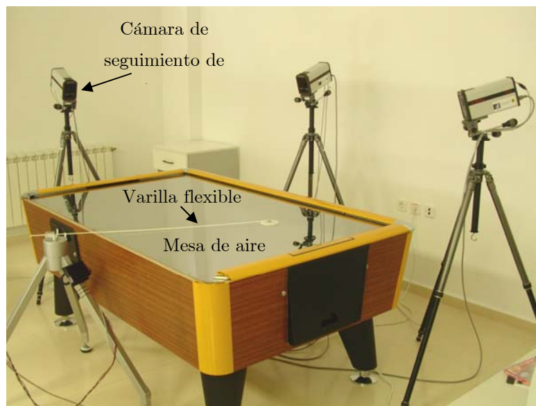
Figura 2.19: Montaje de tres cámaras de seguimiento para la determinación de la posición del extremo de una varilla flexible (Payo y col., 2005) (Laboratorio de Mecánica de los Medios Continuos, ETSII, UCLM)
