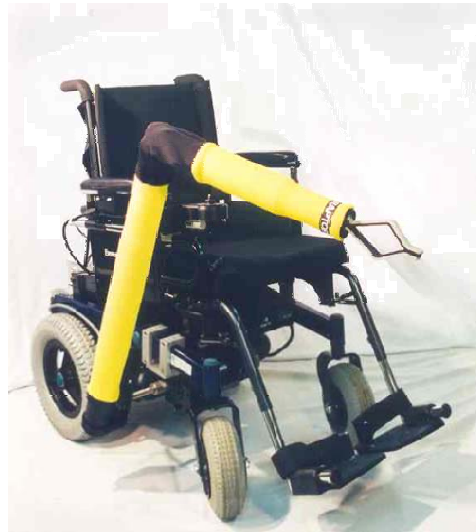
Figura 2.3: Silla con brazo robotizado de asistencia (Phybotics, appliedresources.com )
