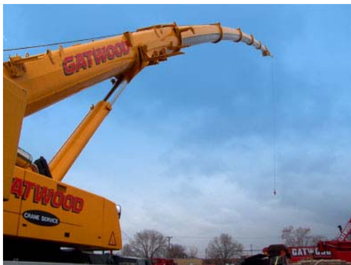
Figura 2.2: Grúa telescópica. Deflexión del extremo
