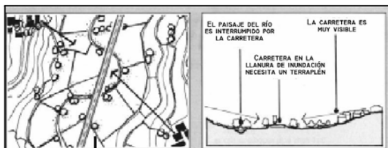
Fig. IV.29.- Mal diseño en fondo del valle, cortando el río varias veces. Además, la carretera ha de ir en terraplén, por lo que es más visible..
