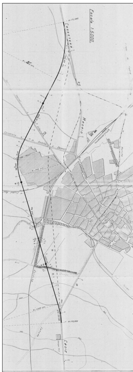
Fig. VI.27.- Proyecto de Variante de 1938. Obsérvese como se debían expropiar algunas construcciones, lo muy cercana a la población que se planteaba la variante y que el Albergue no se veía afectado. Además, las líneas de puntos y discontinuas muestran soluciones consistentes en pasos sobre el ferrocarril, al norte o al sur de la estación, y el mantenimiento de la travesía.
