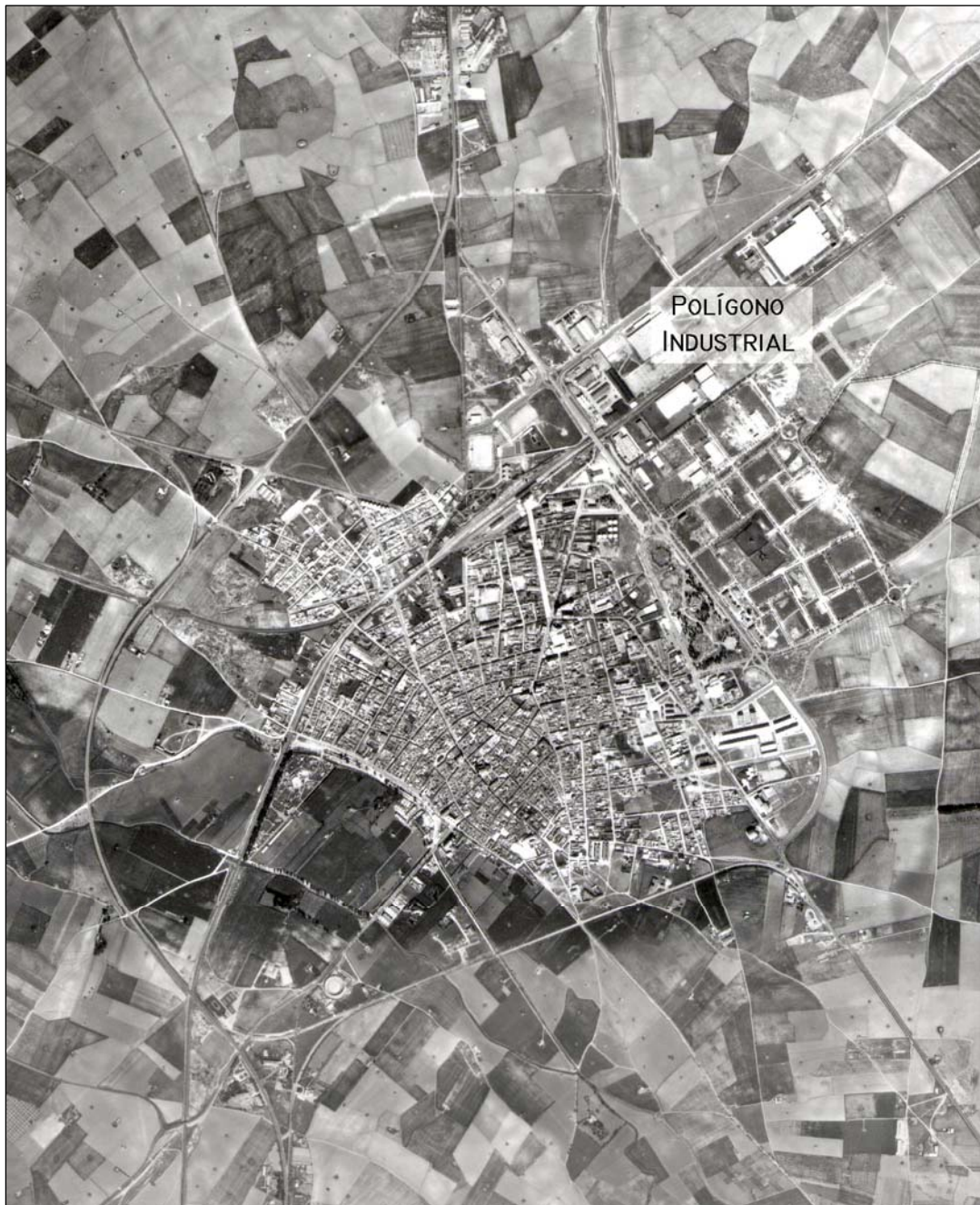
Fig. VI.42.- Fotografía aérea de Manzanares en 1984, poco antes de la duplicación de calzada. El polígono industrial se ubica en el noreste del núcleo y su avenida principal, que a la vez actúa de ronda, une las carreteras de Madrid y Albacete pasando sobre el ferrocarril. De manera indirecta, el esquema de dos variantes estudiado en los años 50 es finalmente construido.
