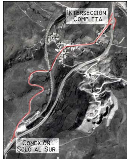
Fig. V.105.- Variante de Cañeda y de un tramo de curvas, conectado al norte de manera completa y al sur solo en dirección a Reinosa.
