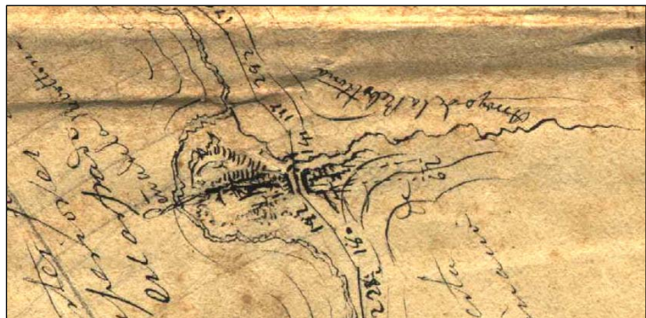
Fig. V.41.- Detalle del plano (ver figura V.24) de mediados del XIX con el paso junto a la Peña de Revoltona. Obsérvese como el río hace un rodeo alrededor de la Peña, el desmonte de esta (que parece un puente) y la obra de fábrica sobre el arroyo de la Revoltona.
