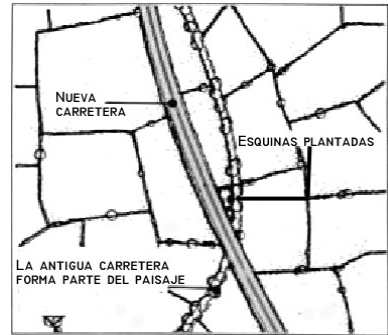
Fig. IV.34.- Conservación de carretera consolidada con vegetación como barrera visual de la nueva.
