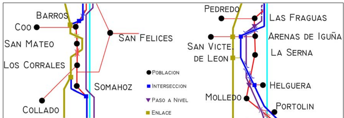
Fig. V.115.- Esquema funcional de los valles de Buelna (izquierda) e Iguña (derecha) tras la construcción de la Autovía. Mientras que en el valle de Buelna, los Accesos, situados en la charnela del valle cederán su espacio a la Autovía, en el valle de Iguña, ésta buscará igualmente la charnela, conservándose los Accesos en el centro del valle.
