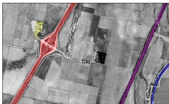
Fig. VI.91.- Gasolinera (en amarillo) construida gracias al enlace del p.k. 210 solicitado por Ayto. de Valdepeñas en un camino poco relevante que no tiene paso sobre el F.C. (morado).
