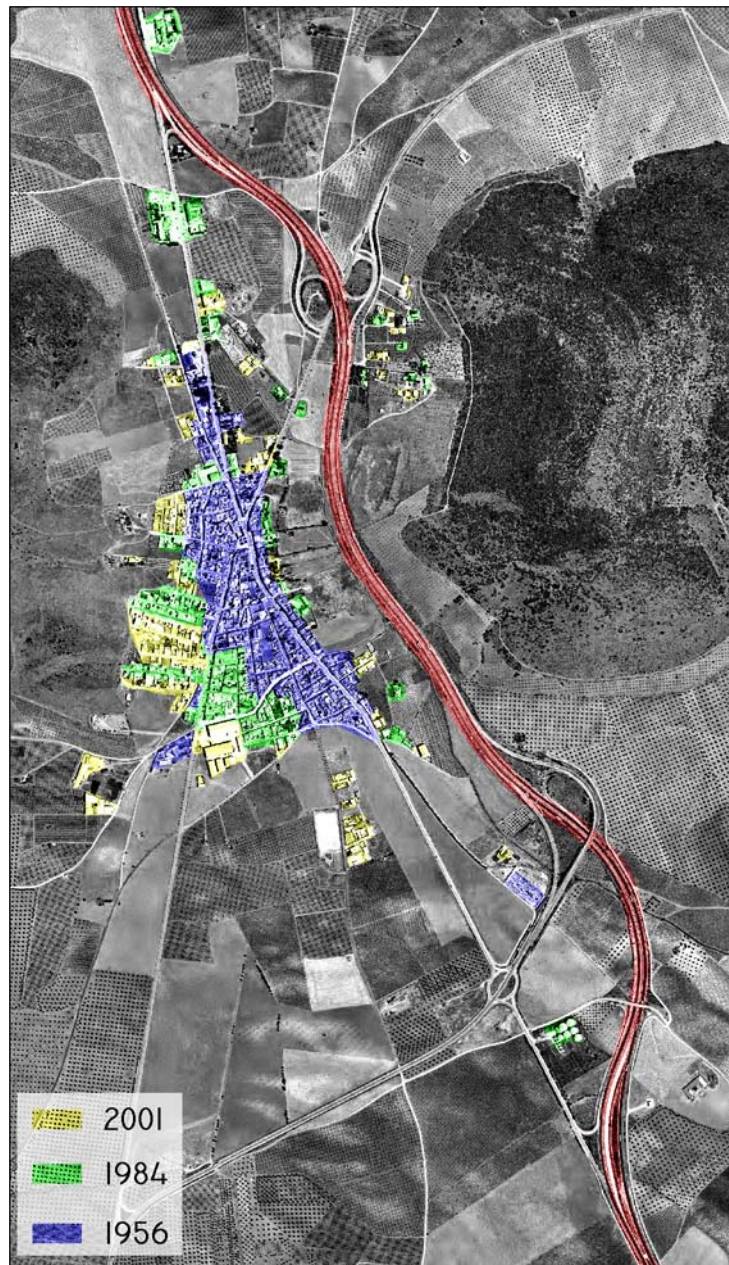
Fig. VI.74.- Evolución de Puerto Lápice. Obsérvese el escaso papel jugado por la variante como consecuencia de la efectiva restricción de accesos (no tiene interés situarse junto a ella), y por estar situada en el borde del cerro.
