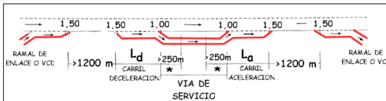
Fig. IV.54.- Conexión directa con la vía de servicio
