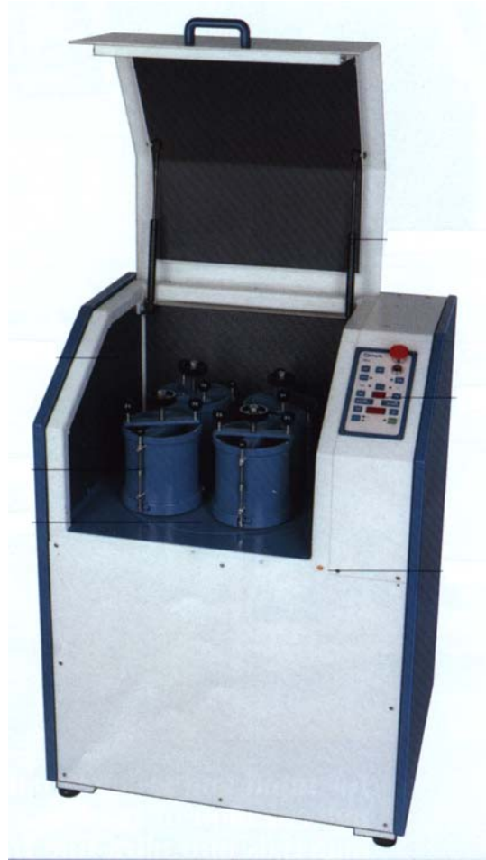
Figura 3.1.- Molino planetario utilizado para fabricar las muestras (Retsch PM4), con las garras de sujeción.
