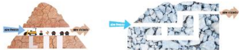
Figura 06. Sistemas de ventilación en minería.
