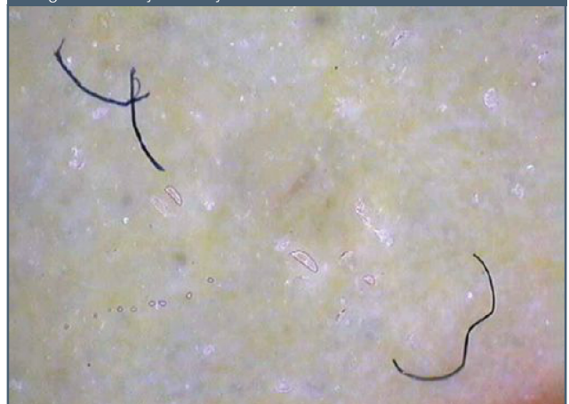
Abbildung 2: Probe 2: Partikel- bzw. Faserstrukturen aus einem ausgefallenen Hydraulikzylinder.
