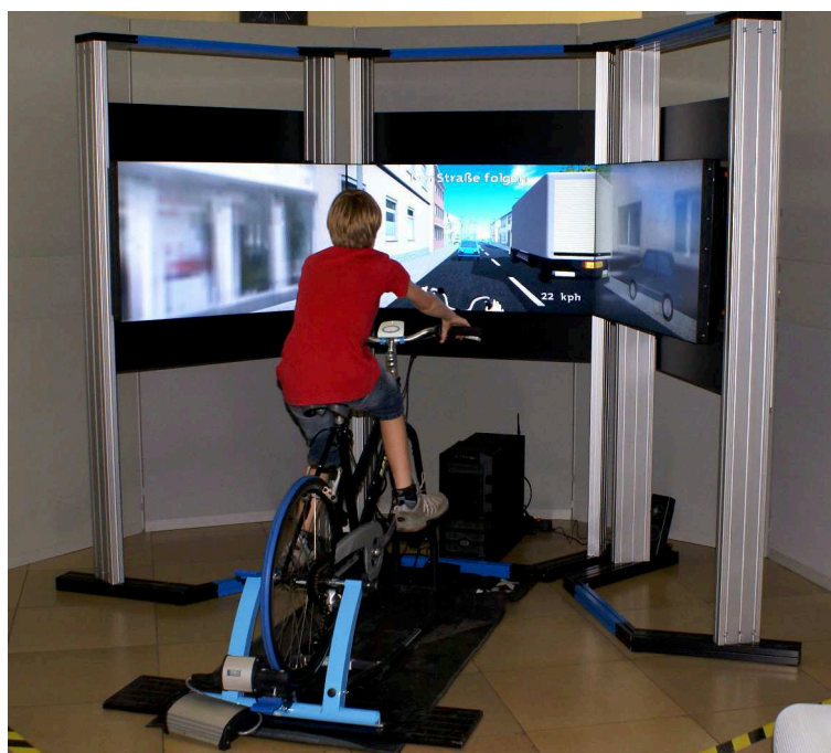
Abbildung 1: Der neue FIVIS-Simulator im Einsatz auf dem Deutschlandfest in Bonn vom 1. bis 3. Oktober 2011. Er besteht aus drei LCD-Flachbildschirmen, die in einem mobilen Aluminiumgestell befestigt sind und in der Höhe auf den Probanden eingestellt werden können.
