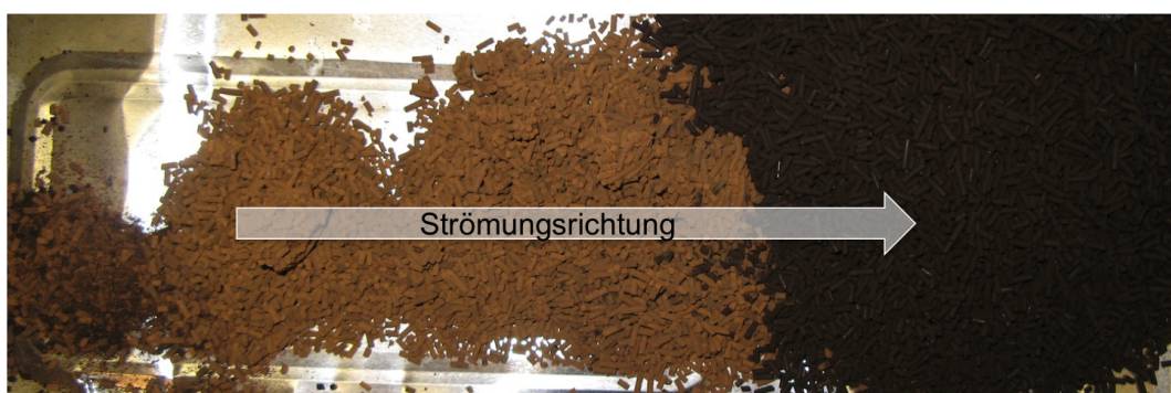
Abbildung 5.3.6: Adsorbens der dritten Schwefelfallenfüllung nach Begasung und verfrühtem Durchbruch; braun = beladenes Adsorbens, schwarz = unbeladenes Adsorbens
