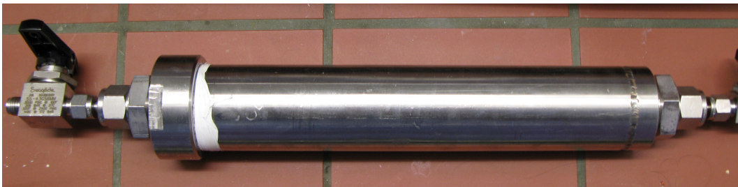
Abbildung 5.3.3: Schwefelfalle für den Einsatz an der Biogasanlage der Nordzucker AG und im Betrieb des SOFC-Biogas-Systems
