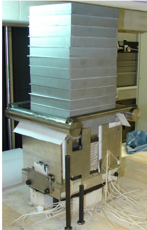
Abbildung 6.1.4: MK200 im Prüfstandsofen, von unten nach oben: Grundplatte, Adapterplatte, Verspannplatte, Stack mit seitlichen Lufthutzen, Verspannplatte, Auflagegewichte
