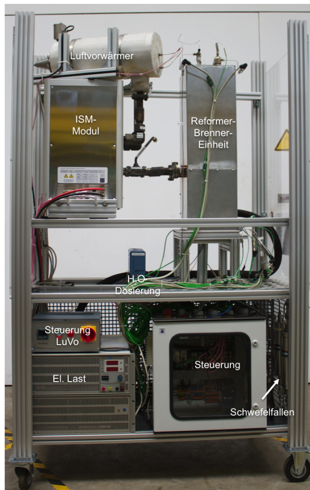
Abbildung 7.2.2: SOFC-Biogas-System ohne Isolierung
