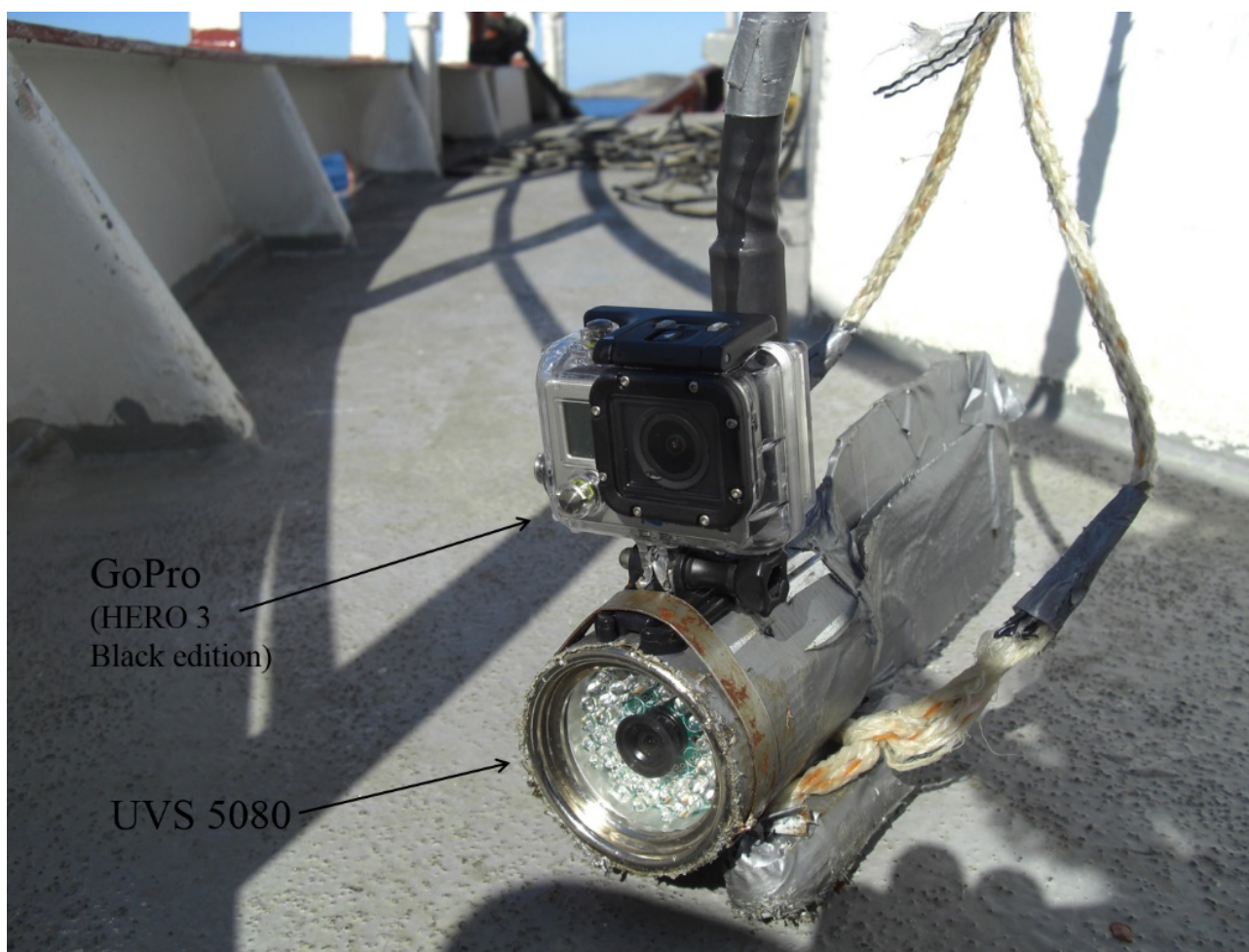
Figur 3. Undervannskamerasystemer benyttet til videundersøkelser i Nordland.
