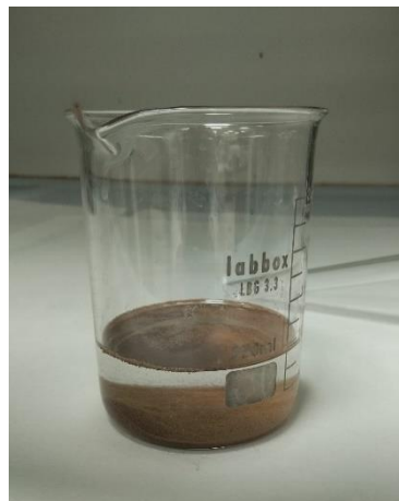
Figura 48: Detalle de la flotación: en la superficie del cloroetileno se encuentran los caparazones (izquierda) y depositada en el fondo la arena o la materia más densa.
