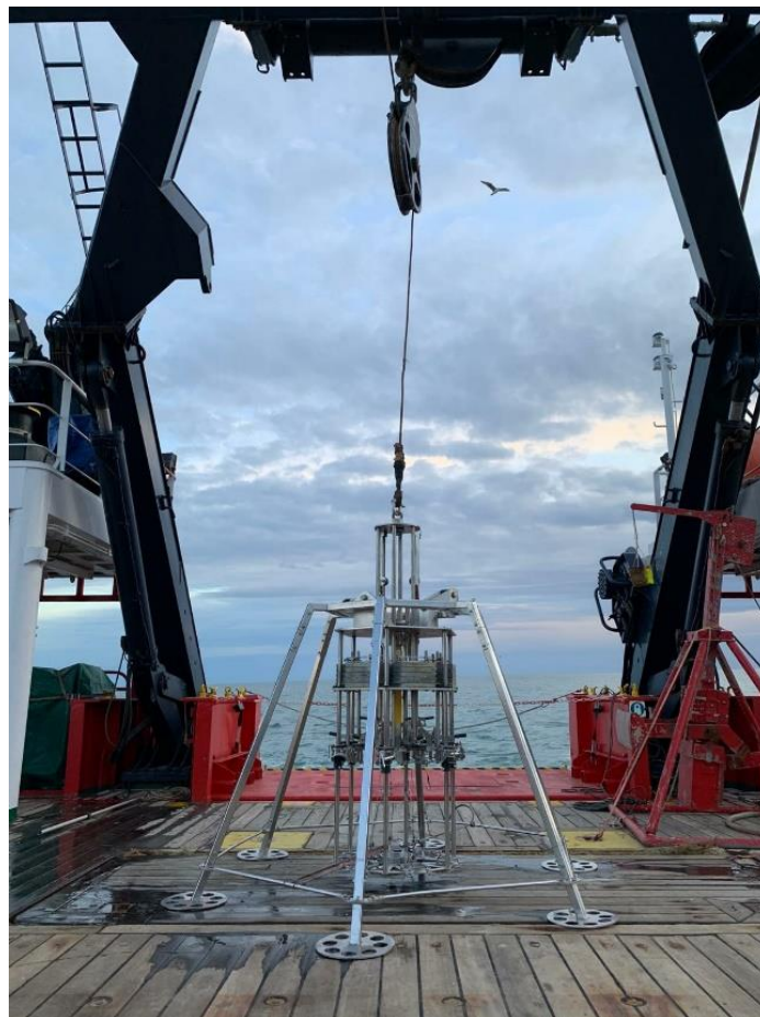
Figura 38: Multimuestrador multicorer de la casa KC Denmark. Fuente: fotografía tomada a bordo por Sandra Romero
