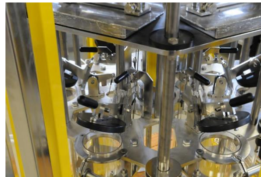
Figura 40: Detalle de las tapas superiores y abrazaderas. Fuente: KC-DENMARK (2020)
