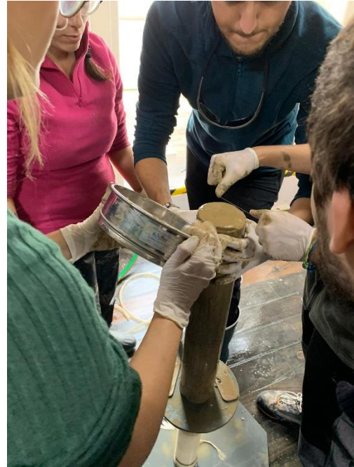
Figura 46: Sección del primer centímetro del testigo para la obtención de la muestra de foraminíferos superficiales.
