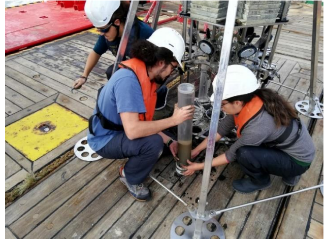
Figura 44: Extracción del tubo y disposición sobre la abrazadera
