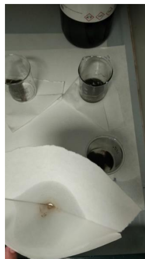
Figura 50: Caparazones retenidos en el filtro y restos de arena permanecen en el vaso
