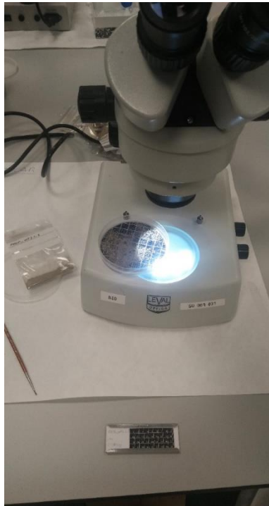
Figura 51: vista de la bancada de trabajo, con la muestra, la placa Petri cuadrículada sobre la lupa binocular, y el portaobjetos micropaleontológico.
