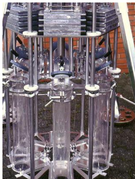
Figura 39: Multimuestreador armado para la toma de muestras. Fuente: KC-DENMARK (2020)
