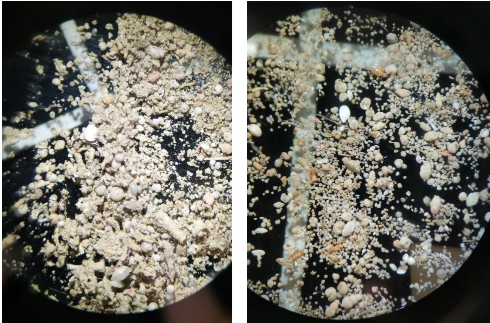
Figura 53: Vista a través de la lupa binocular de las muestras previas a la flotación (izquierda) y tras realizar la flotación (derecha).
