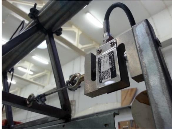
Figura 5.3- Célula de carga DYLY-103, limitada a 10 kg .
