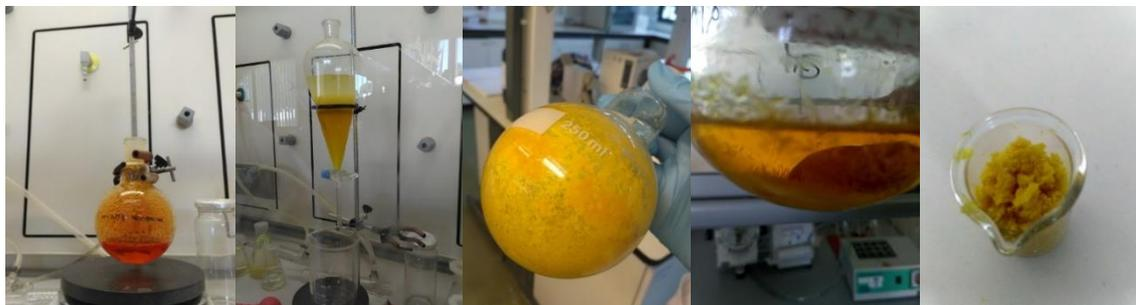
**Figura 11.** Procedimento da síntese da 2,9-dimetil-1,10-fenantrolina-5,6-diona: (da esquerda para a direita) solução em agitação na placa após adição do  $\text{KBrO}_3$ ; extração líquido-líquido com água-diclorometano; evaporação do composto; recristalização em metanol aquecido; composto final.
