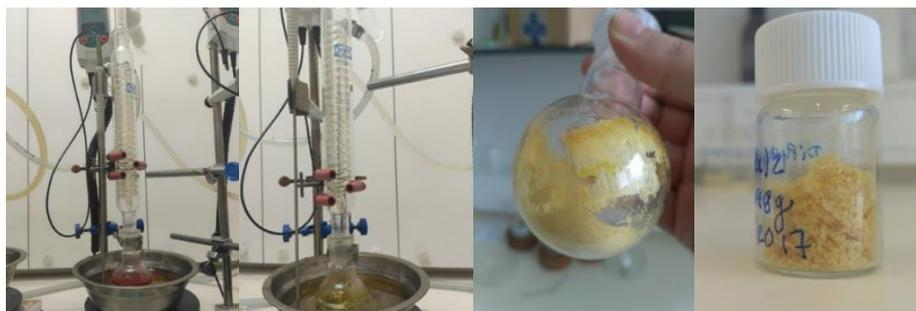
**Figura 13.** Procedimento final da síntese do DiPyPhen(Me)<sub>2</sub>: (da esquerda para a direita) solução em refluxo; a solução mudou de cor no final do tempo de refluxo, de vermelho para amarelo torrado; formação de cristais durante o processo de recristalização; composto final.
