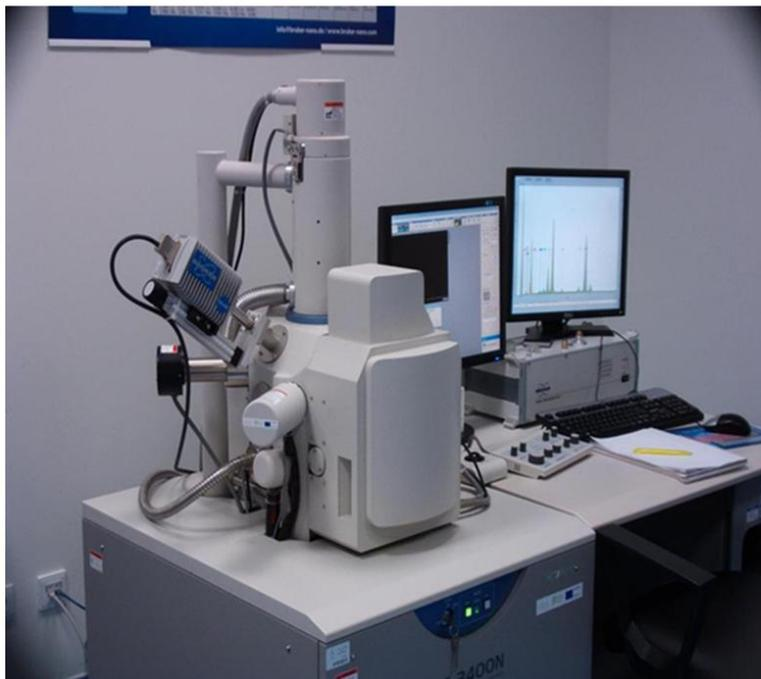
Figura 10 - Fotografia do microscópio eletrónico de varrimento, modelo S-3400N da Hitachi. Laboratório de Microscopia Eletrónica do Centro de Óptica da Universidade da Beira Interior.
