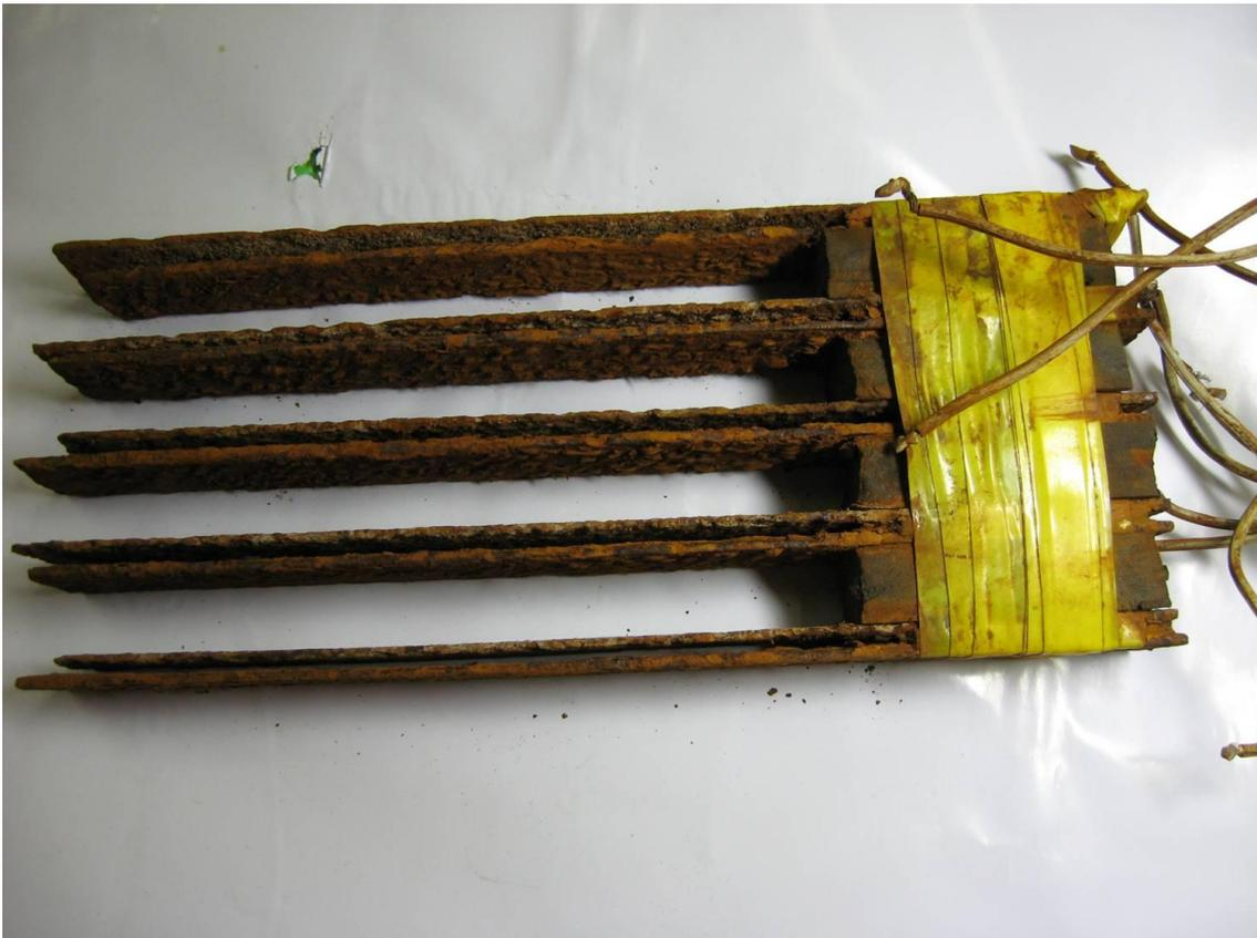
写真 27. 汚泥を除去した電極 B
