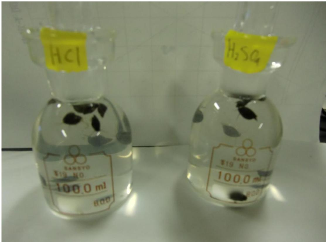
写真 16.  $\text{H}_2\text{SO}_4$  及び、 $\text{HCl}$  を用いたサカマキガイの死滅実験
