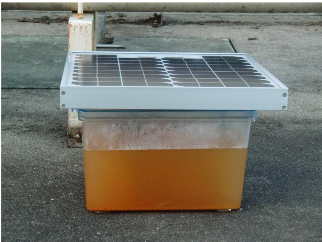
写真 18. 太陽光パネルによる鉄の電気分解の実験（パネルあり・1日目）
