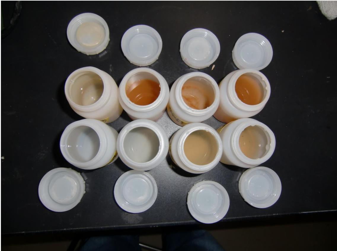
写真 22. 太陽光パネルを用いた鉄板の電気分解の変化の推移
