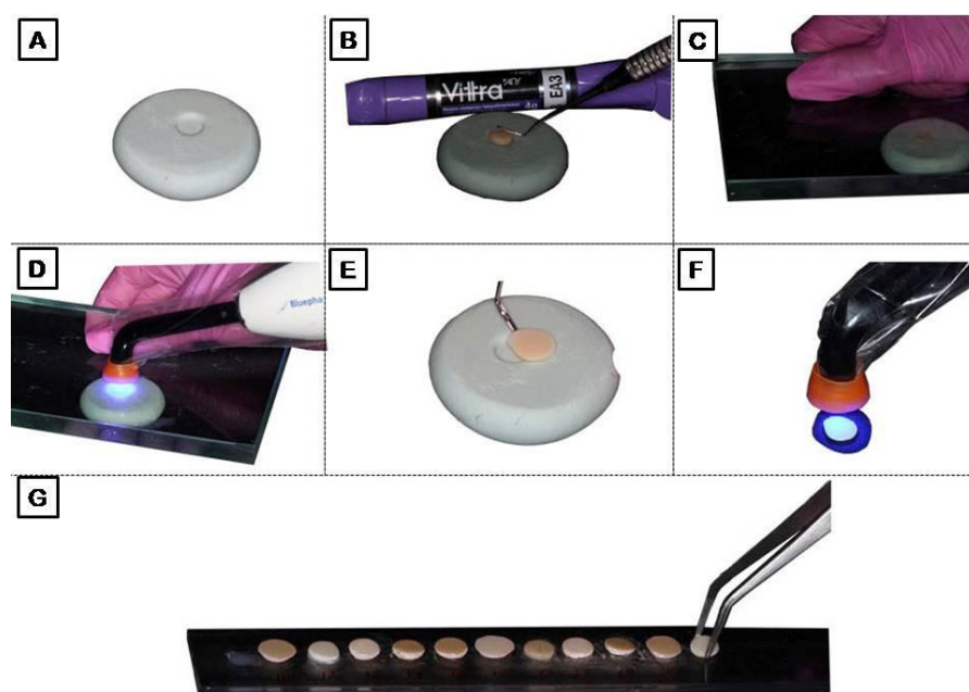
Figura 1: Sequência do preparo dos espécimes de resina. A: molde de silicone previamente preparado com dimensões 8mmx5mm e 1mm de espessura; B: resina Vittra APS (FGM, Joinville, Brasil) sendo ajustada ao molde; C: pressão com placa de vidro; D: fotopolimerização por 20s; E: remoção do espécime do molde; F: fotopolimerização fora do molde por mais 20s; G: fixação dos espécimes em réguas.
