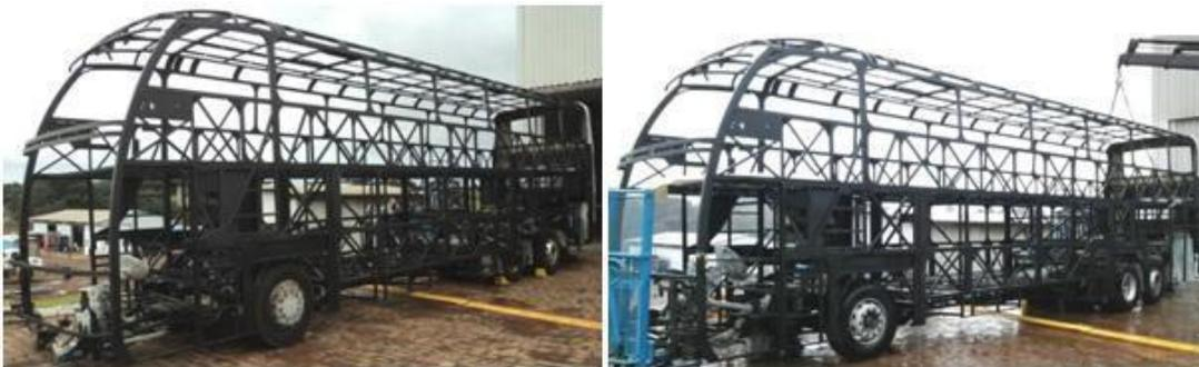
Figura 14 - Acoplamento do casulo nos chassis Mercedes-Benz e Volvo B11R, respectivamente
