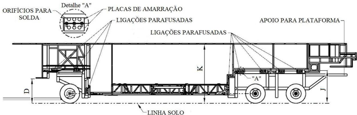
Figura 12 - Esquema de ligação da estrutura móvel para o protótipo
