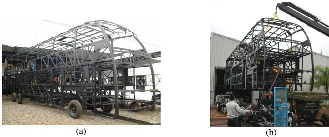
Figura 13 - Montagem final da carroceria protótipo e acoplamentos nos chassis
