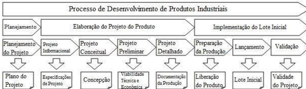
Figura 2 - Representação do processo de desenvolvimento integrado de produtos de Back et al. (2008), adaptado
