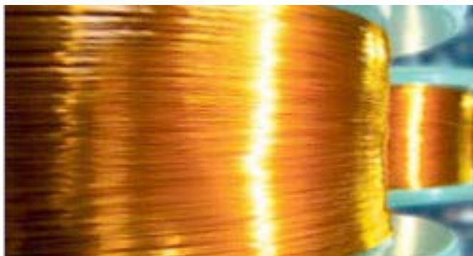
Abbildung 16: Bei der Beschichtung von Drähten wird viel Wasser als Kühlmittel benötigt
