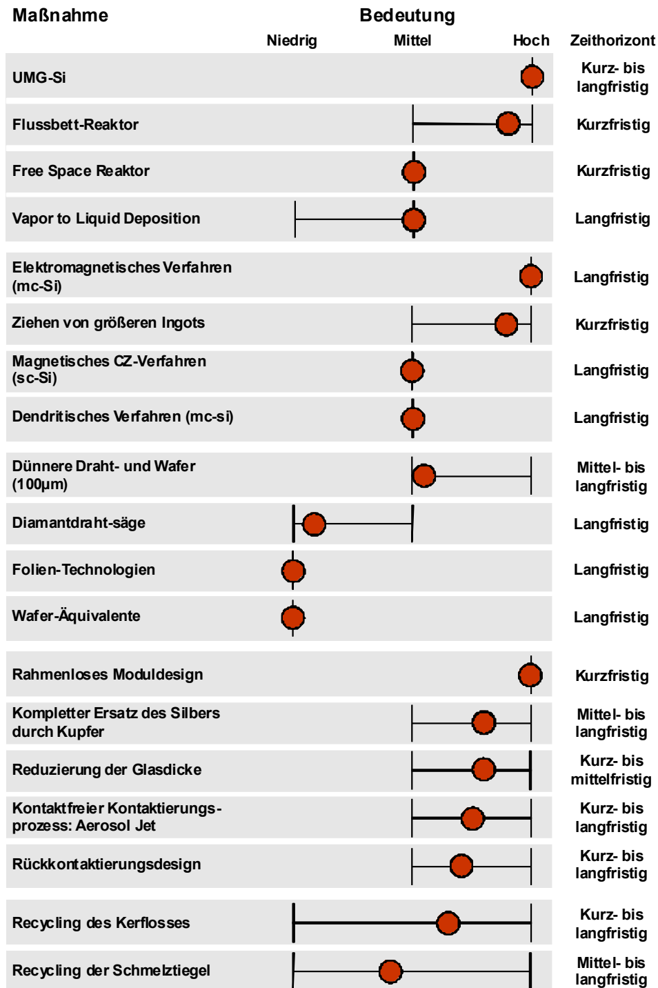
Abb. 34: Relevanz und Zeithorizonte von Maßnahmen bei der Fertigung von c-Si-Modulen
