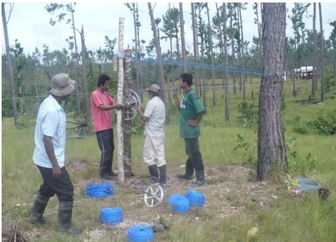
*Foto 7: Capacitación en traslado con cables para zonas que no permitían la extracción vía fuerza humana, facilitada por José Soza, de Masangni.
