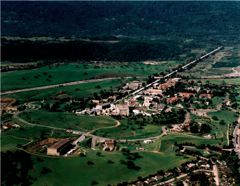
13. ábra. A stanfordi 50 GeV-os lineáris gyorsító. Erre a ma már meglévő lineáris gyorsítóra alapozva épül az első szabadelektron röntgenlézer
