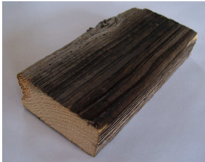
1. ábra. Kezeletlen zsaluléc-darab 17 év után
