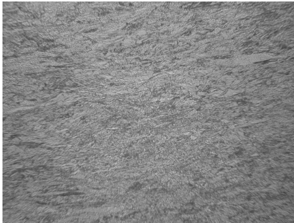
Zömített titán próbatest, p_h=0 MPa, \varepsilon=0,5
