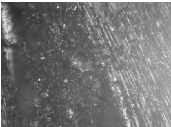
12/c. A szálak közötti pirokarbon koptatás előtti állapotban (X20)
