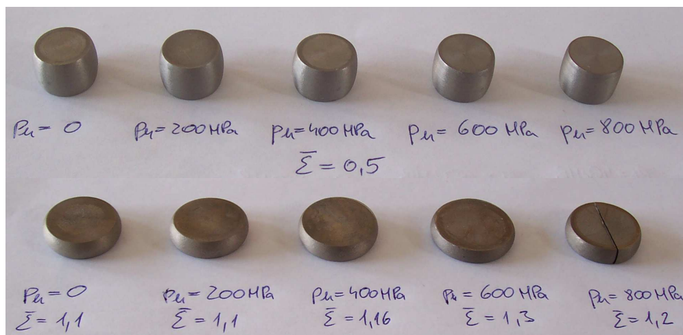
69. ábra. Titán zömítő próbatetek
