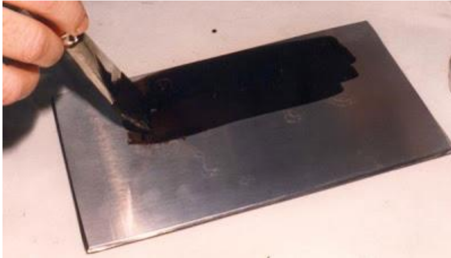
Slika 5: nanašanje zaščitnega premaza (asfalta)
