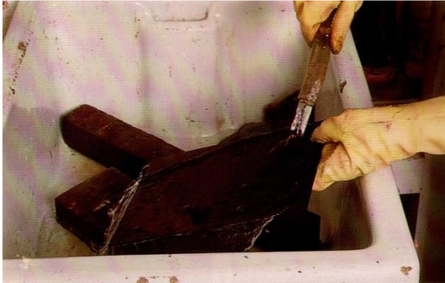
Slika 8: spiranje odvečne kisline s plošče
