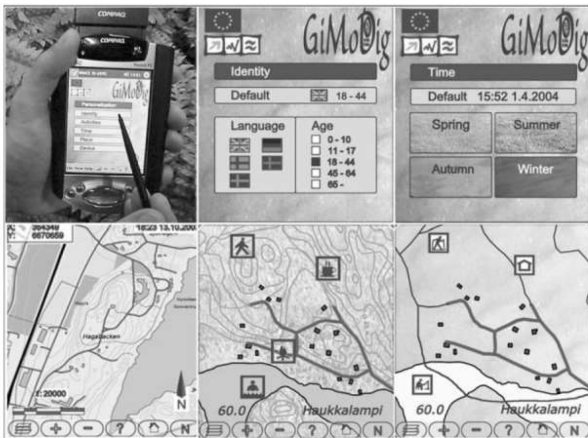
Slika 66: Po osebni nastavitvi podatkov v mobilno napravo se zemljevidi avtomatsko prilagodijo različnim uporabnikom za različne namene rabe (Nivala & Sarjakoski, 2005, 14)
