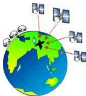
Slika 7: Sprejemnik z mobilno napravo na lokaciji X trenutno prejema signale s štirih satelitov
