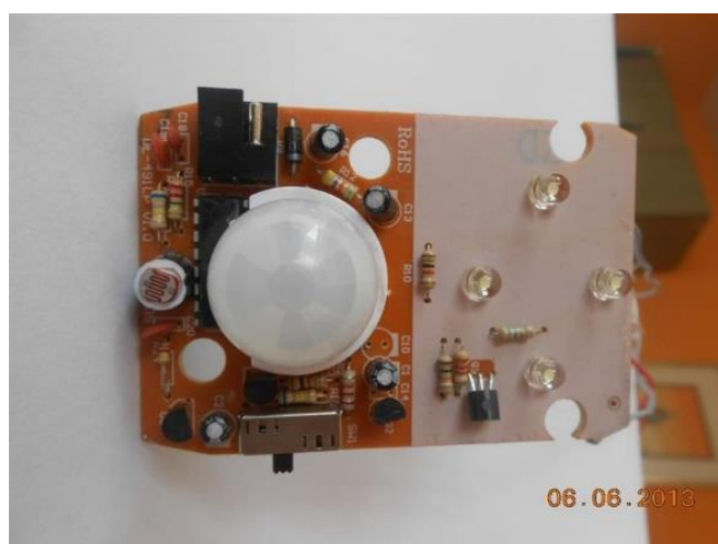
Slika 3.19: Na tiskanem vezju se nahajajo PIR senzor in 4 LED diode
