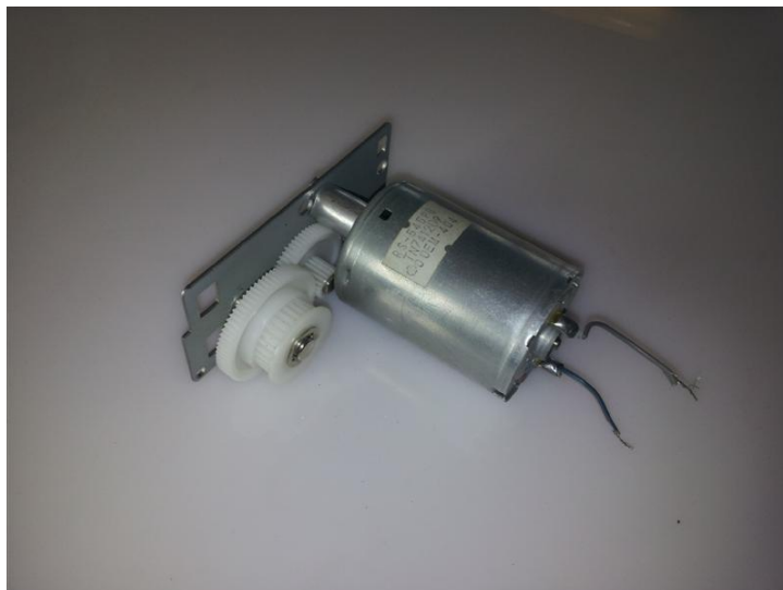
Slika 6.7: Pri pritrditvi elementa z zobniki na koračni motor uporabimo distančnik
