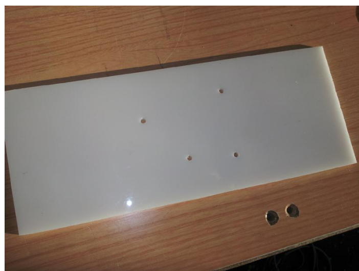
Slika 6.10: V kos akrilnega stekla izvrtamo luknje pritrditev vezja s PIR senzorjem
