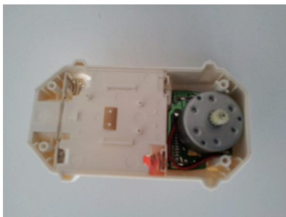
Slika 3.15: Po odvijanju zadnjih vijakov vidimo pravo notranjost osvežilca
