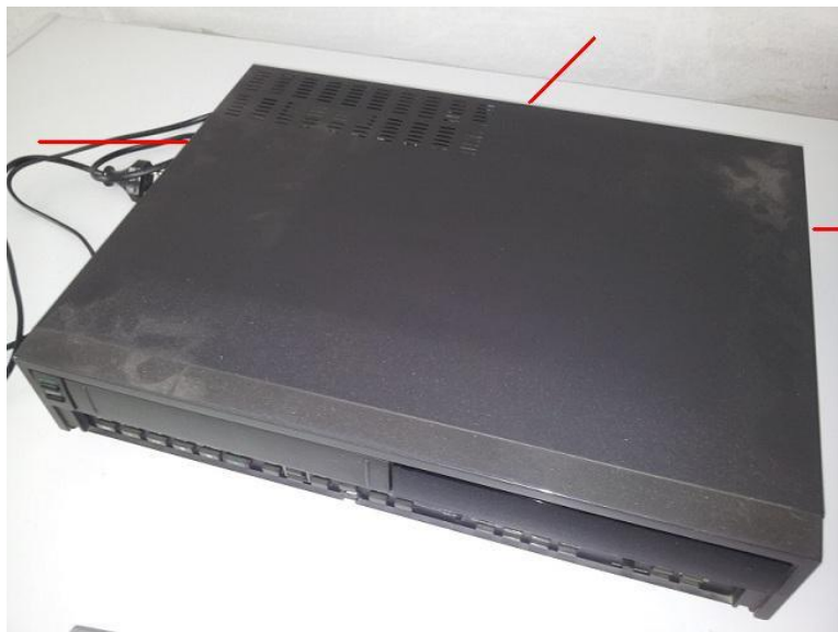
Slika 3.9: Z rdečo so označeni vijaki za odprtje Samsung VHS 1560K
