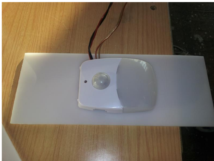
Slika 6.11: Vezje s Pir senzorjem pokrijemo z originalnim pokrovom in pritrdimo na že pripravljeno ploščico (temnejši žici sta namenjeni povezavi z mikrokrmilnikom, svetlejši pa napajanju senzorja)
