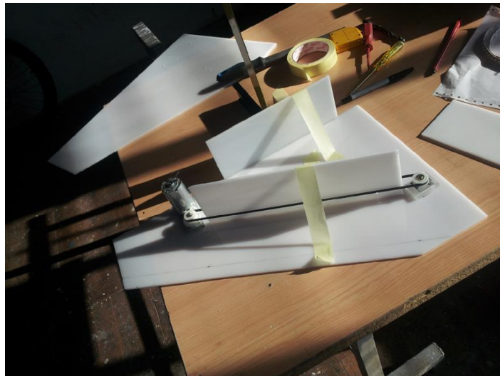
Slika 6.9: Prilepimo še eno ploščico med trak in drugo na spodnji del ogrodja
