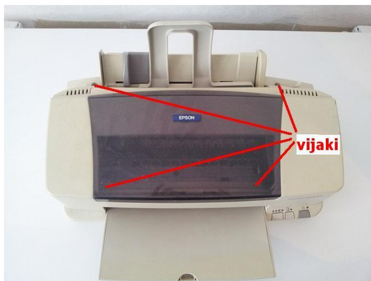
Slika 3.2: Epson P156A je zaprt le s 4 vijaki
