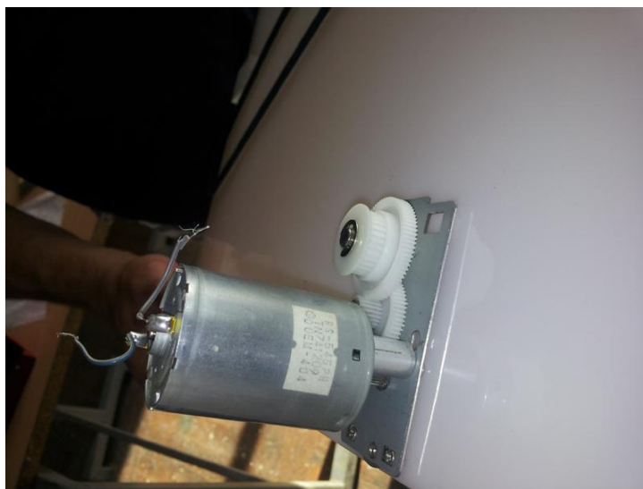
Slika 6.6: Motor z zobniki pritrdimo na akrilno (pleksi) steklo
