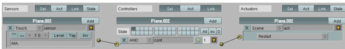
Slika 40: Prizor se ponovno zažene ob dotiku objekta z avtomobilom
