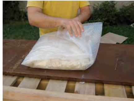
Paso 4 _ se cierra el pluribol, para que se mantenga el agua dentro.
