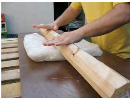
Paso 5 _ Se "amasa" con un cilindro de madera, hacia delante y hacia atrás, para que el Blousse se afielare, luego se gira y se amasa en la otra dirección para compensar las contracciones del material al afieltrarse.
