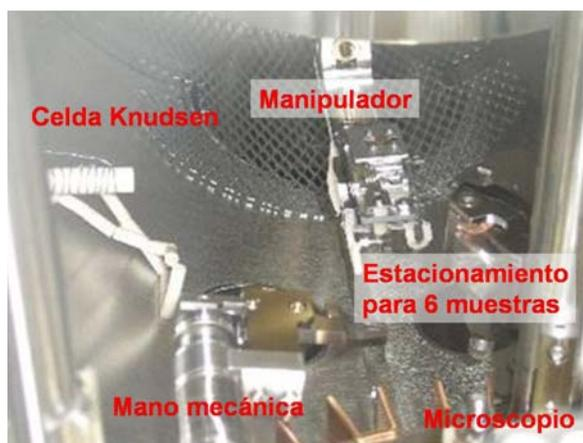
Figura 5: Foto del interior de la cámara donde se muestra al manipulador con la muestra de Si, el evaporador de las moléculas y la mano mecánica.
