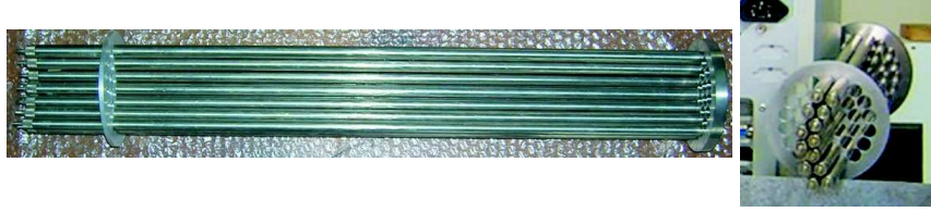
Figura 5.2: Muestra empleada para los experimentos de detección de uranio natural. Consiste en trece vainas de un manojo combustible tipo Atucha I limitado a 50 cm. Cada vaina tiene una longitud de 50 cm y un diámetro externo de aproximadamente 1 cm. En su interior contienen pastillas de UO_2 sin enriquecimiento.
