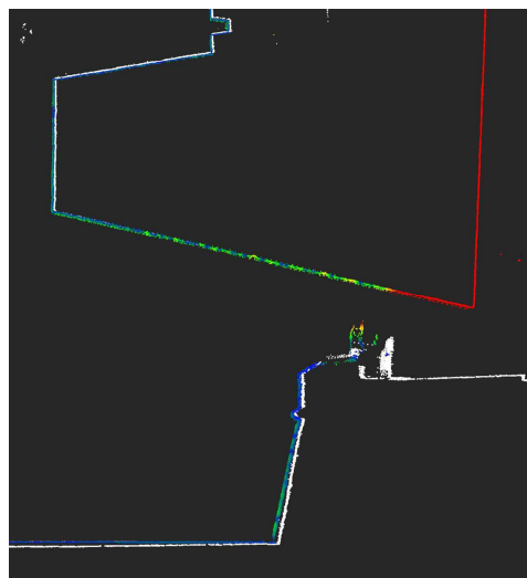
Fig. 7. Confronto tra le banche dati ottenute dai rilievi svolti con laser scanner FARO (database bianco) e laser scanner mobile KAARTA (database colorati).
