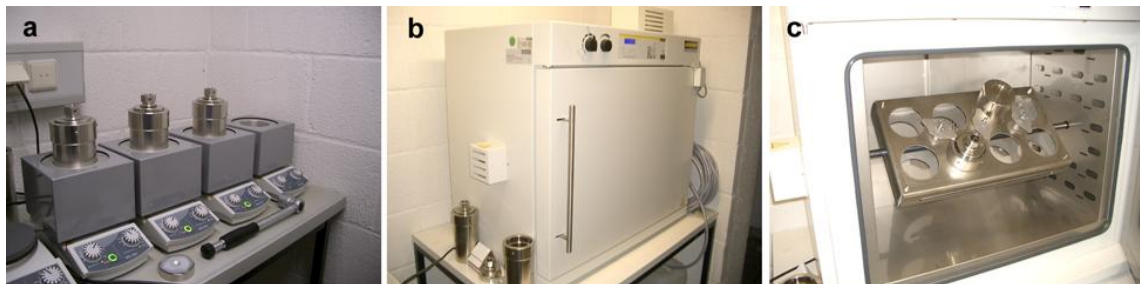
Abbildung 3-1: a: Heizblöcke und Autoklaven der Firma Berghof; b, c: Ofen der Firma Nabertherm mit rotierender Aufnahme für Stahlautoklaven (Spezialanfertigung).
